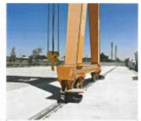
Durch die gleichzeitige, gegenläufige Schließung des Zwillingspartikularwerks wird die Last ohne Halterumänderung gehoben und gewirkt und kann exakt positioniert werden.
